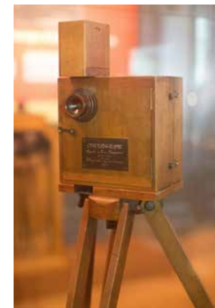
הסינמטוגרף של האחים לומייר – מצלמה ששימשה גם כמכשיר הקרנה ופיתוח בעידן הראינוע
