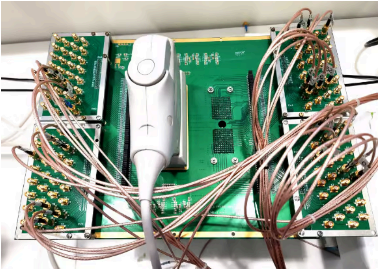
אפשר לפרוץ את הגבולות הפיזיקליים ולקבל יותר מידע בפחות השקעה. אבטיפוס של מערכת האולטרסאונד הרפואי המתקדם (צילום באדיבות מעבדת אלדר)
